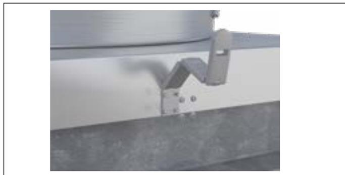
**ÉTAPE 3 :** Percez (4) trous de 0,19 au centre de la costière du toit, à 2" entre le bord de l'adaptateur pour costière et le bord supérieur de l'attache.
