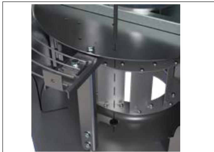
**ÉTAPE 3 :** Fixez le bulbe thermostatique à l'aide d'une attache sur la tige de support verticale la plus proche.
