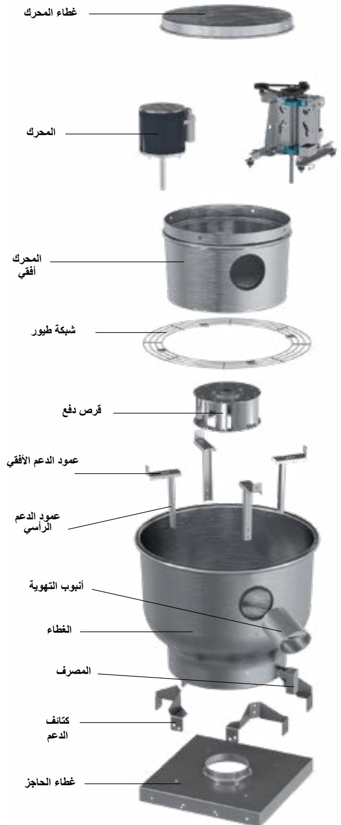
مروحة الدفع العلوي، الطرازات PCU و PCUB
